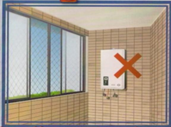
3 加裝窗戶的陽台
